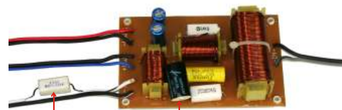
Widerstand (1.5 - 5.6 Ohm) in der Plusleitung des Hochtonsystems zur Absenkung des Hochtonpegels
