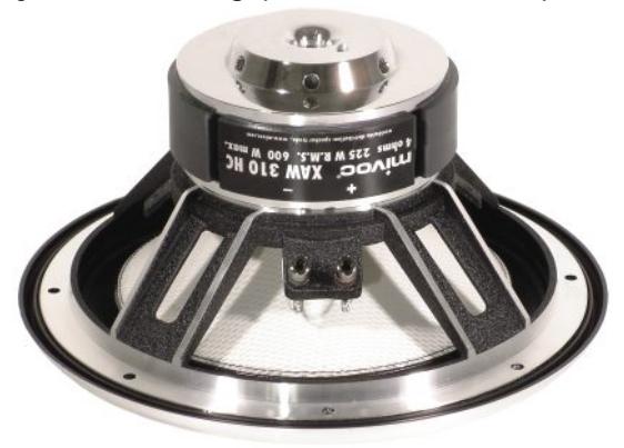
Aufwendige Belüftung von Magnet-system, Schwingspule und Zentrierspinne
